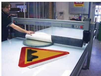
ガラスストップ・テーブルの下には、16本の蛍光灯が装備されています。ライトテーブルのように使用できるので、FFなどの張り合わせも正確に行うことができます。
